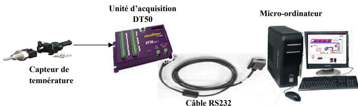
Fig.A1.3 Architecture du système d'acquisition des données
