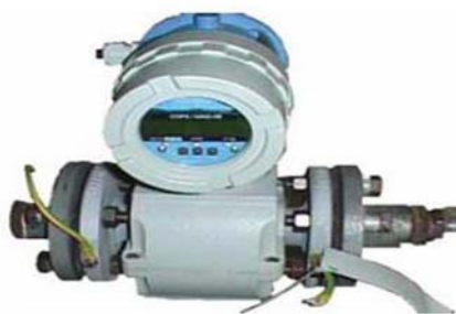
Fig.A1.7 Le débitmètre électromagnétique utilisé
