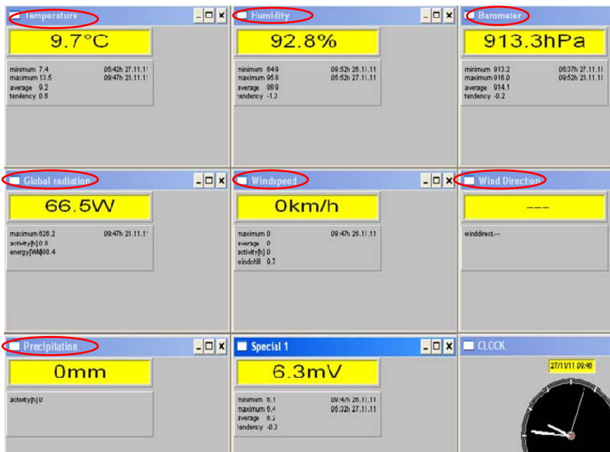
Fig.A1.12 Interface d'affichage des données de la station météorologique
