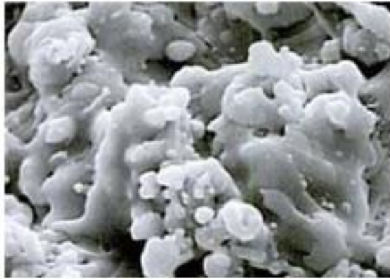
Figure 27: Surface obtenue par plasma-spray hydroxyapatite [41].
