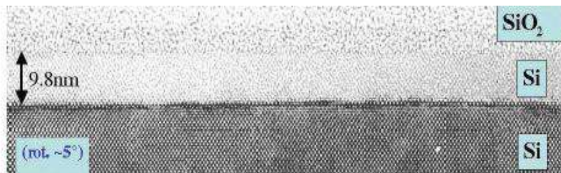
Figure II.18 - Microscopie électronique en transmission en vue en coupe de l'interface de collage, d'un échantillon dont la rotation vaut environ 5^\circ . [38]
