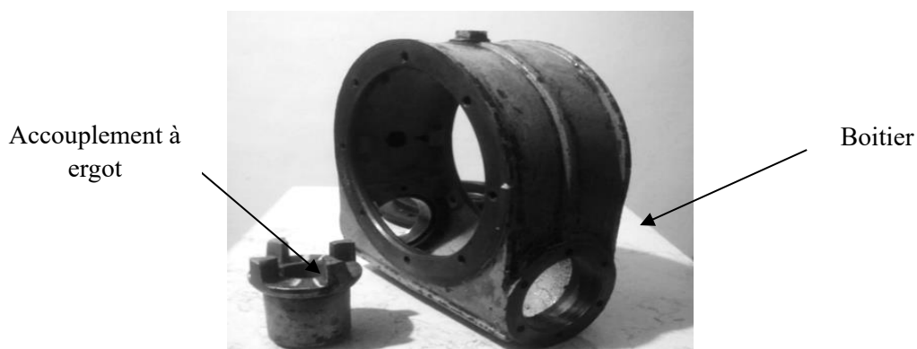
Fig. III.13: Accouplement à ergot et boîtier du réducteur
