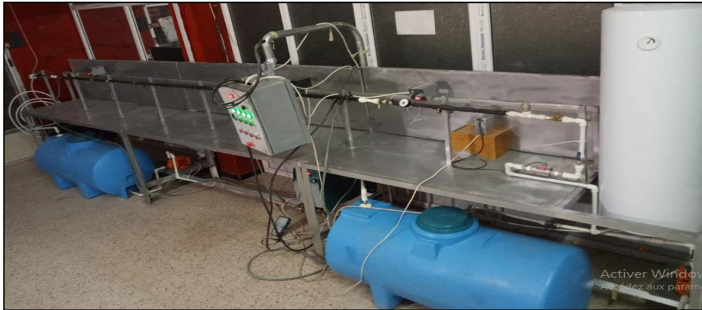
Fig. IV.19: Installation expérimentale d'un tube droit (validation de dispositif)
