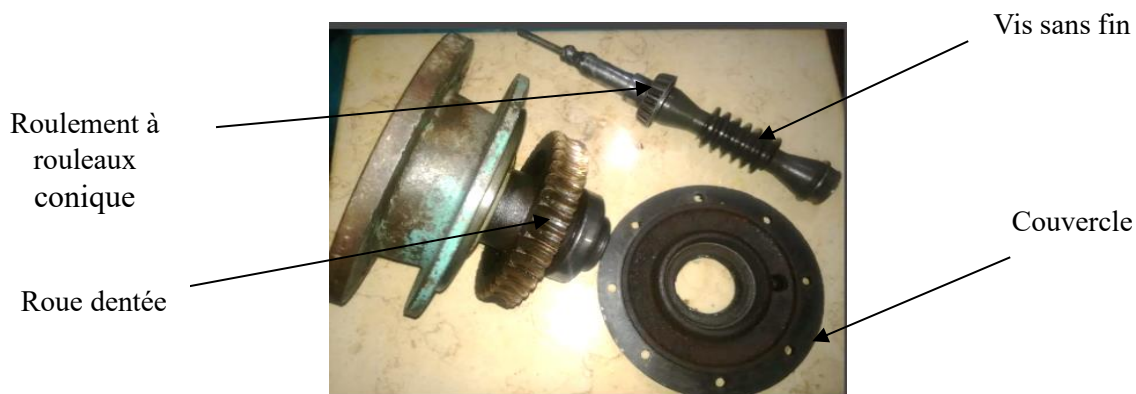
Fig. III.12: Vis sans fin et la roue dentée du 1 er réducteur
