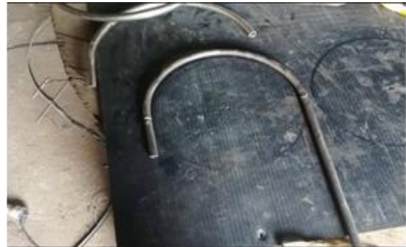
Fig. III.21: Mise en position du tube pour un rayon R_c = 80\text{mm}
