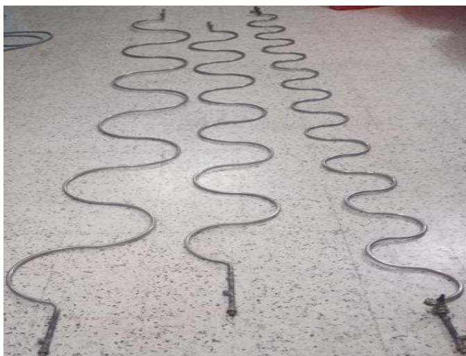
Fig. III.23: Tubes longitudinalement courbés en C cycliquement inversés, pour différents rayons de courbure
