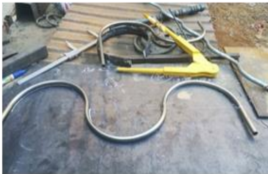
Fig. III.20: Mise en position du tube pour un rayon R_c = 120\text{mm}
