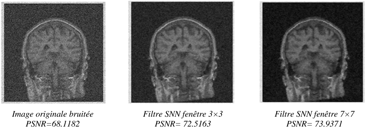
Figure 2.14 Application d'un filtre SNN.
