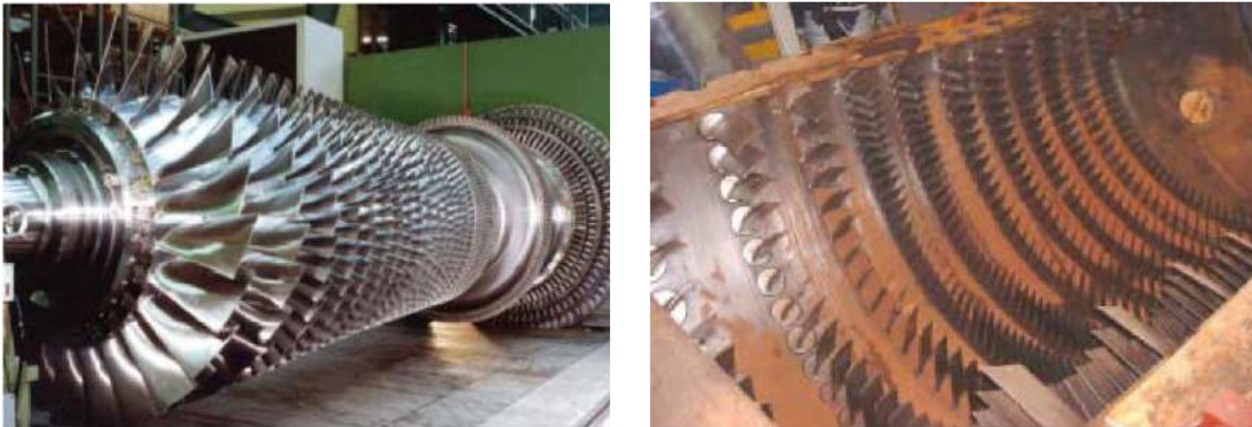
Fig.2.17. Rotor et stator d'un compresseur axial.
