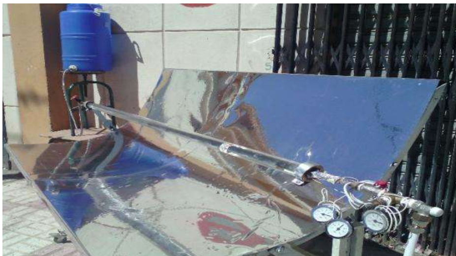
Figure 4.6: Capteur solaire cylindro-parabolique avec le miroir S-Reflect
