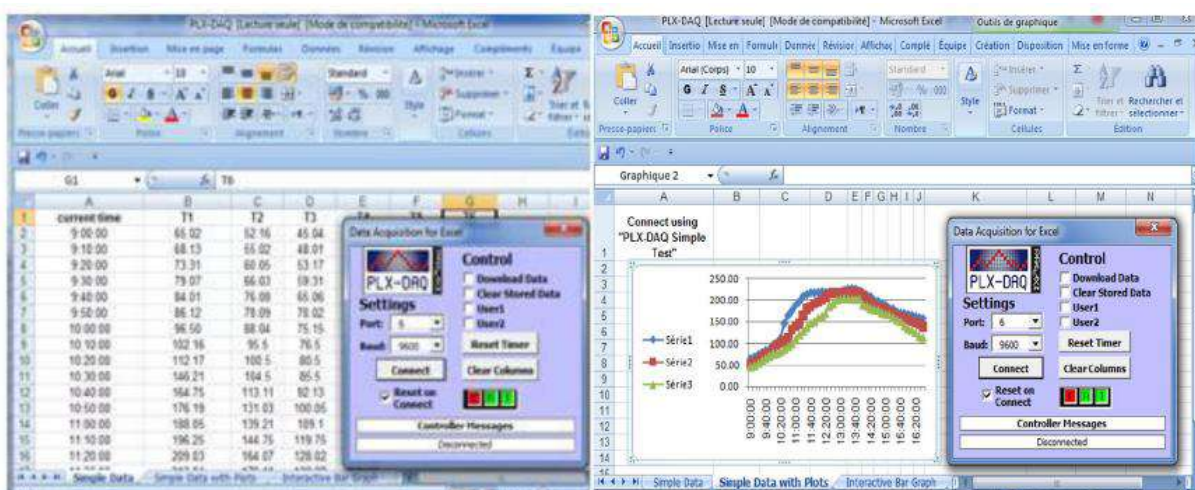
Figure 4.17: Affichage des températures via la carte d'acquisition développée
