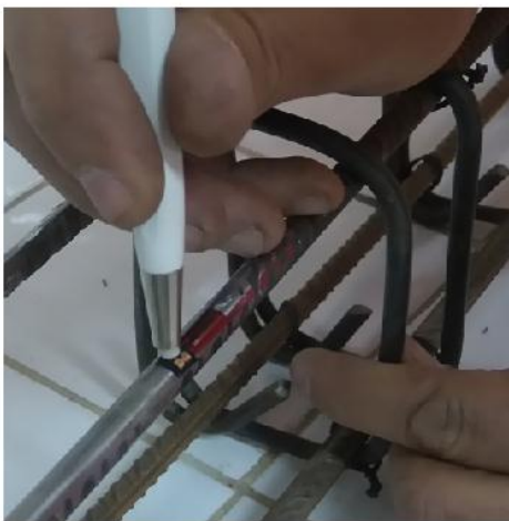
Figure B. 5 Manipulations pour la prise et la fixation de la jauge de déformation sur le ferrailage
