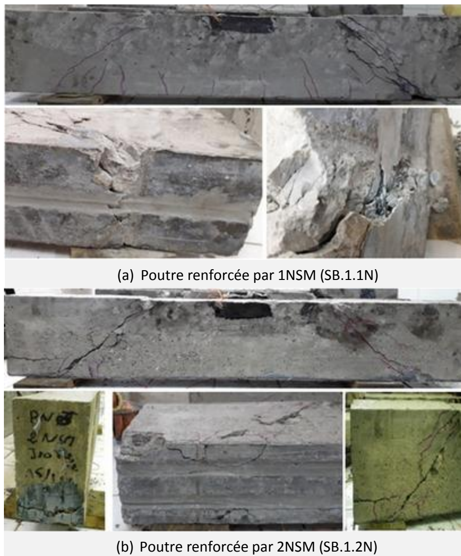
Figure 4. 5. Mode de rupture des poutres renforcées selon la technique NSM.
