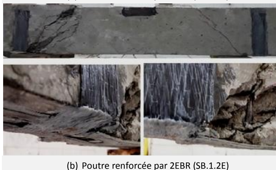
Figure 4. 4. Mode de rupture des poutres renforcées selon la technique EBR.
