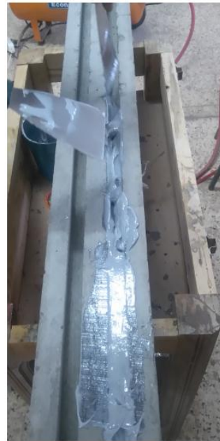
Figure A. 3. Préparation de surface, traçage et application de la résine pour le renforcement selon NSM.
