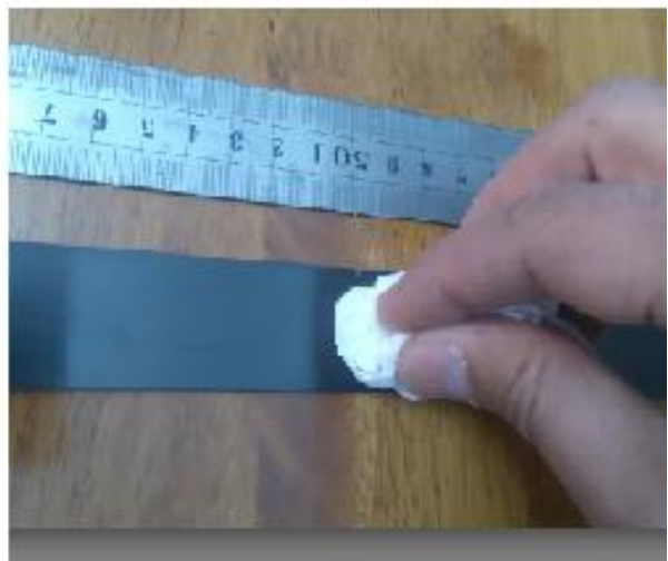
Figure B. 3. Nettoyage de la surface du renfort par les produits solvants, catalytiques et neutralisant.
