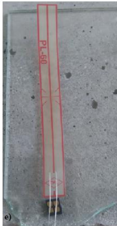
Figure B. 2. Fixation de la jauge sur le béton.
