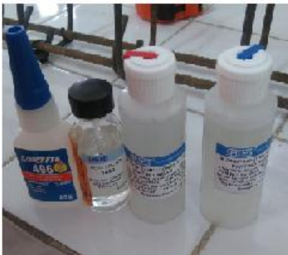
Figure B. 3. Nettoyage de la surface du renfort par les produits solvants, catalytiques et neutralisant.
