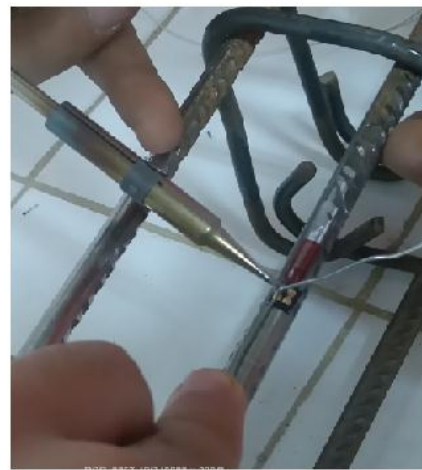
Figure B. 5 Manipulations pour la prise et la fixation de la jauge de déformation sur le ferrailage
