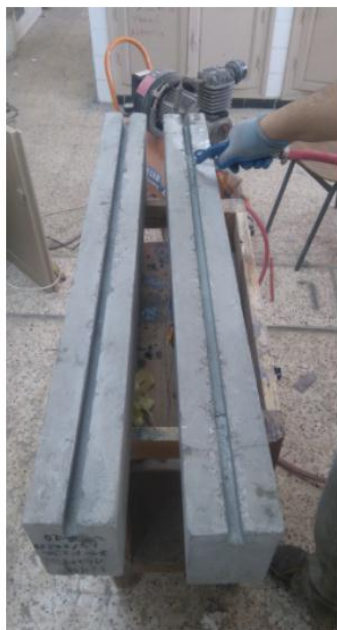
Figure A. 3. Préparation de surface, traçage et application de la résine pour le renforcement selon NSM.
