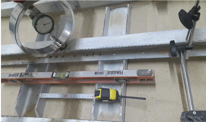
Figure III.8 Photos des semelles au moment de chargement.
