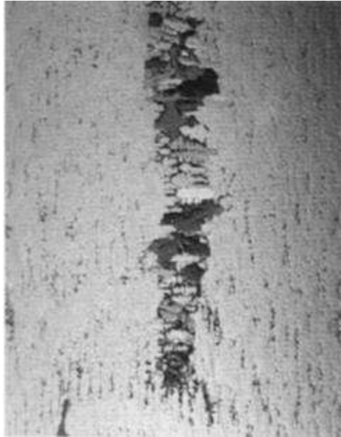
Figure. I.10. Gros plan d'un seul Freckles dans un superalliage à base de nickel. Le Freckles présente un diamètre d'environ 2 mm, M.C. Schneider et al [22].
