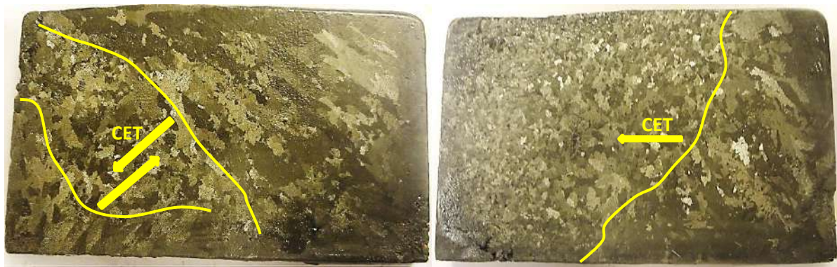
(a) Cas-I : sans brassage électromagnétique convection Sn-10wt.%Pb (réf LH19)
