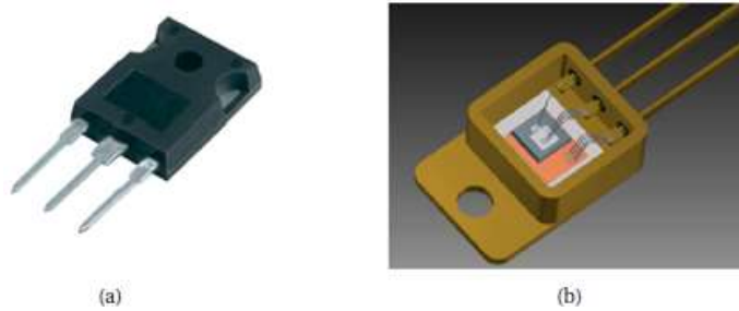
Figure 1.24: Boitier discret to 247 en (a) EPOXY (b) métallique
