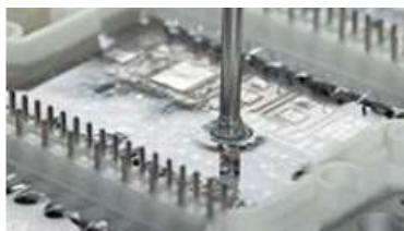
Figure 1.23: Encapsulation d'un module de puissance par un gel silicone transparent
