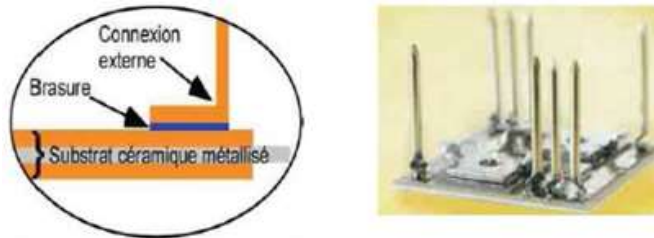
Figure 1.22: Connecteurs externes brasés sur la métallisation du substrat
