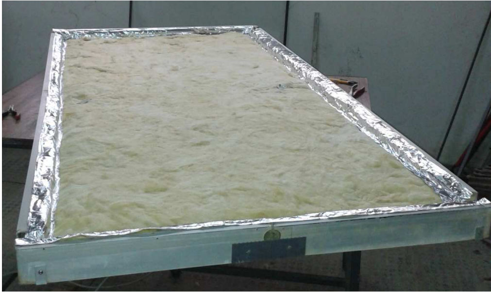
Figure. B-5 : Rénovation de la couche d'isolation avec de la laine de verre
