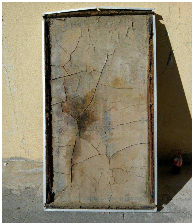
Figure. B-2 : Couche d'isolation du capteur plan (en état de dégradation après une longue période de son exposition au soleil).
