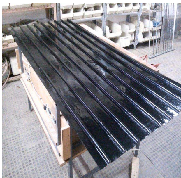
Figure. B-4 : Rénovation de l'absorbeur par l'ajout de la peinture noire sur toute sa surface.
