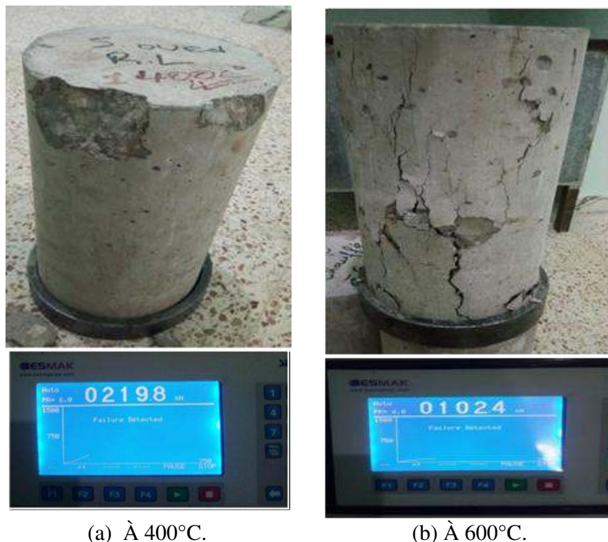
Figure III.17 Test d'écrasement à la presse des éprouvettes en béton à base de sable d'Oued
