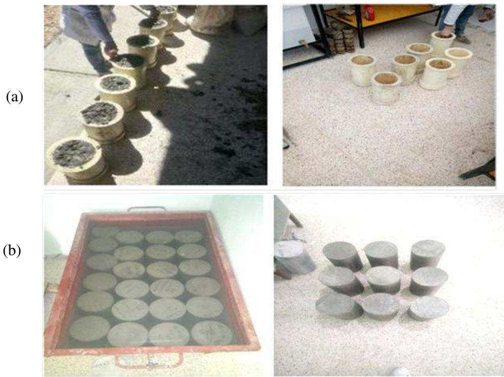
Figure III.9 Confection des éprouvettes(a), démoulage et conservation des éprouvettes (b)
