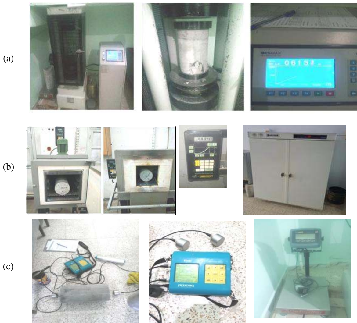
Figure III.10 Equipement et instrumentation (a) Machine de compression, (b) Four électrique avec contrôleur de température et étuve de séchage, (c) Appareil d'ultrason, scléromètre et balance
