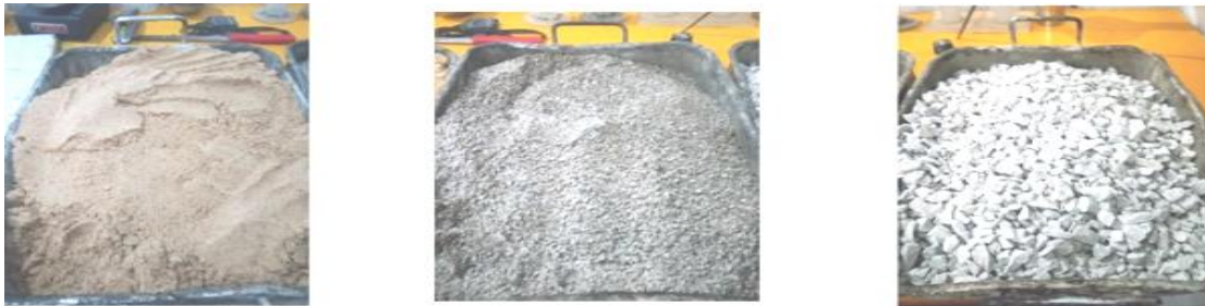
Figure III.2 Différents granulats utilisés (sable de dune, sable de carrière, gravier 15/25)
