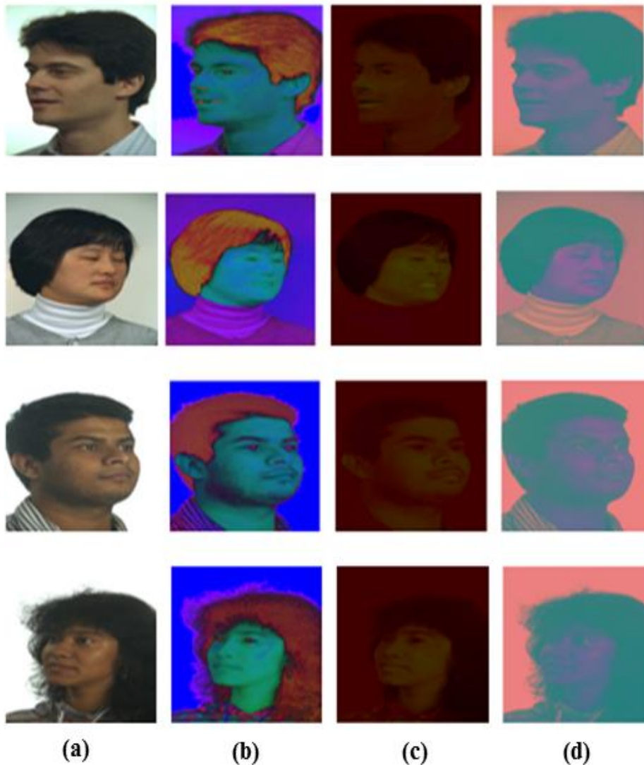
Fig.4. 4 — Exemple d'images faciales originales correspondant à différentes teintes de peau, représentées dans les quatre espaces colorimétriques. (a) RGB. (b) HSV. (c) YUV. (d) YCbCr.
