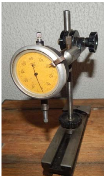
Fig.10. Comparateur utilisé pour la mesure du cratère et schéma de mesure de KT
