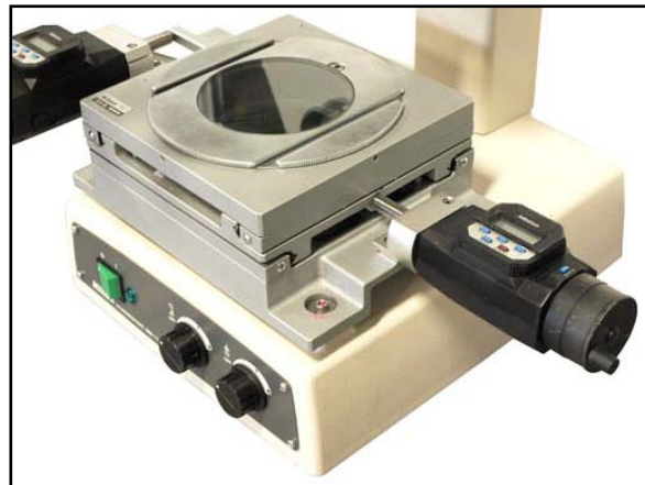
Fig.8. Image montrant les deux tambours du microscope (longitudinal et transversal).
