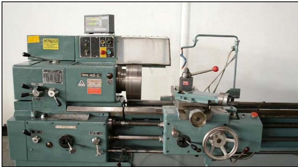
Fig.1. Machine outil TOS TRENCIN SN 40 C utilisée lors des essais d'usinage
