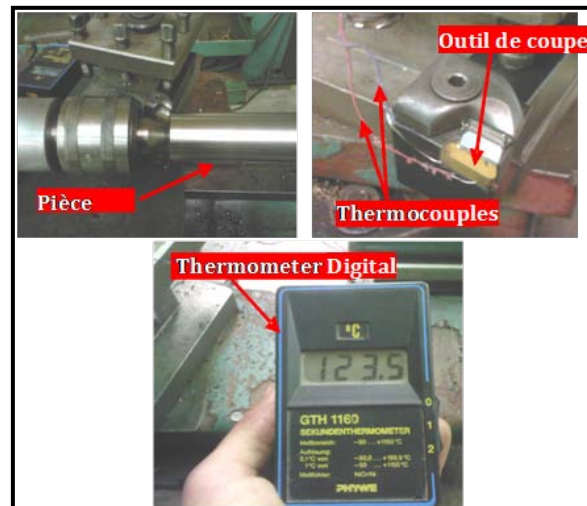
Figure.1. Dispositif de mesure de la température de coupe avec thermocouples
