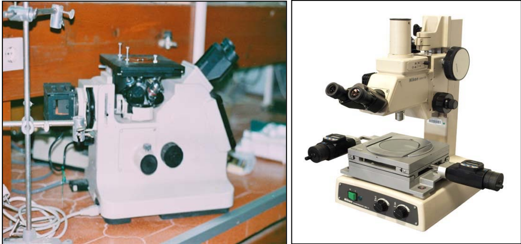
Fig.7. Microscopes optiques utilisé pour l'observation et le suivi des profils d'usure.
