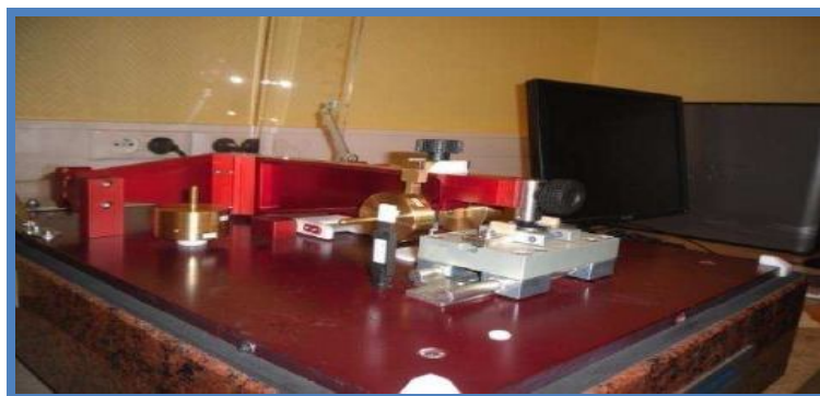
Figure II.15 : Tribomètre configuration Pion/Plan CER Arts et Métiers Paris Tech [7].
