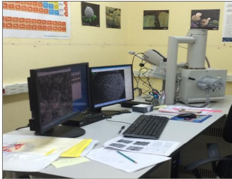
Figure V.1 : Vue d'ensemble du microscope électronique à balayage.
