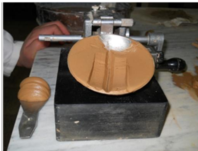
Figure III.13 : Appareil de Casagrande
