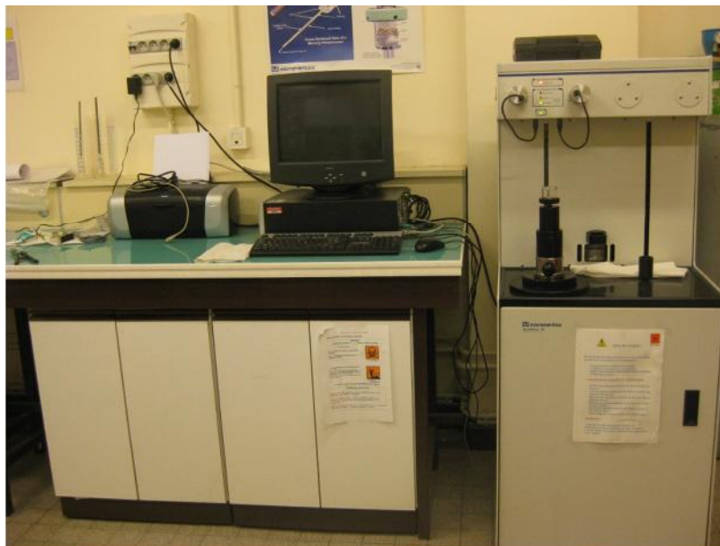
Figure V.6 : Vue d'ensemble d'un porosimètre à mercure
