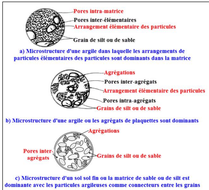
Figure I.19 : Différents types de microstructures de sols fins (Alonso et al. 1990)
