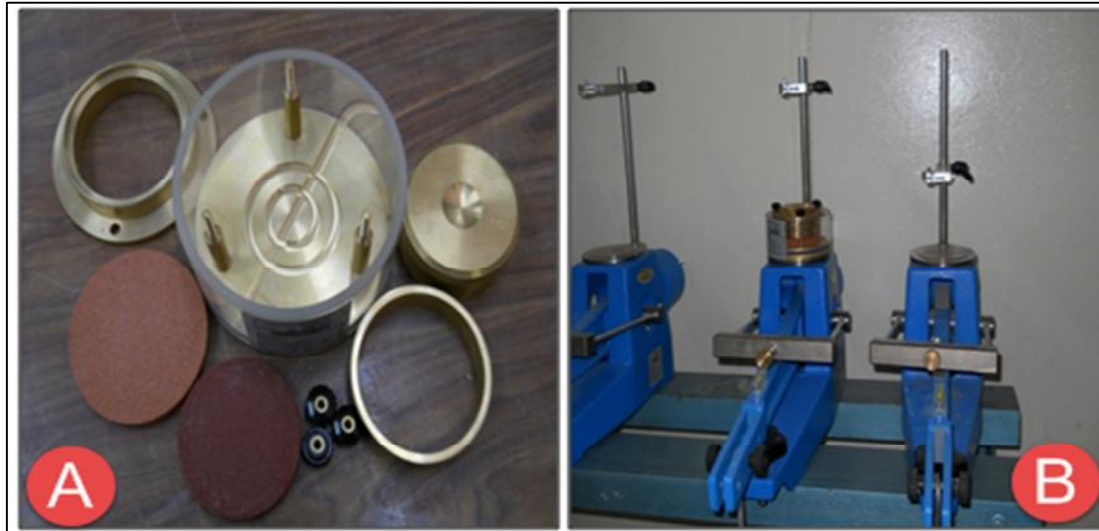
Figure III.17 : Cellule Oedométrique (a) et appareil oedométrique (b)
