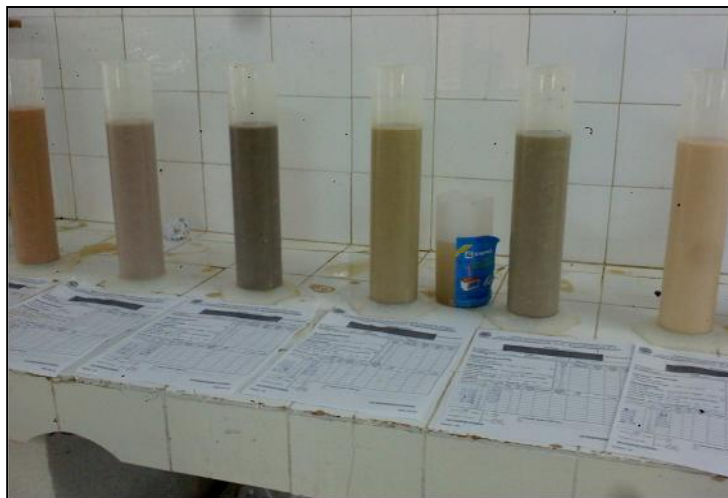
Figure III.11 : L'essai de sédimentométrique
