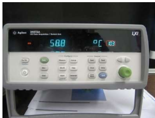
Figure 2.5 Centrale d'acquisition Agilent 34972A (acquisition des températures)
