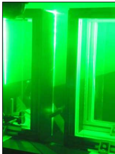
(b) Chambreensemencée par la fumée de l'huile Shell Ondina
