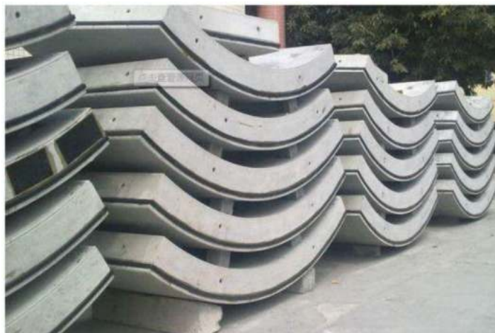
Figure 1.23 Segments préfabriqués empilés.
