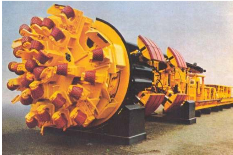
Figure 1.12 Tunnelier à appui radial
