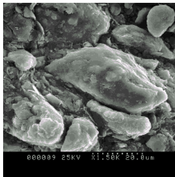
Figure 7.22 Photo montrant le phénomène de rotation des grains (Essai XKIO ; Echantillon H – 1500X)
