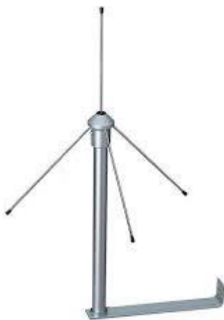
Figure I.12 Antenne monopôle avec réflecteur incliné.
