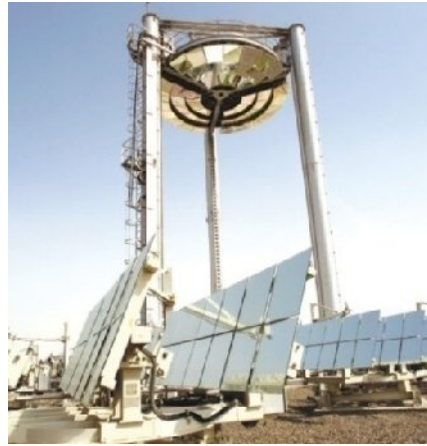
Figure I.8. Le concentrateur solaire avec une seconde réflexion en haut de tour dans la ville de Masdar, Abu Dhabi.
