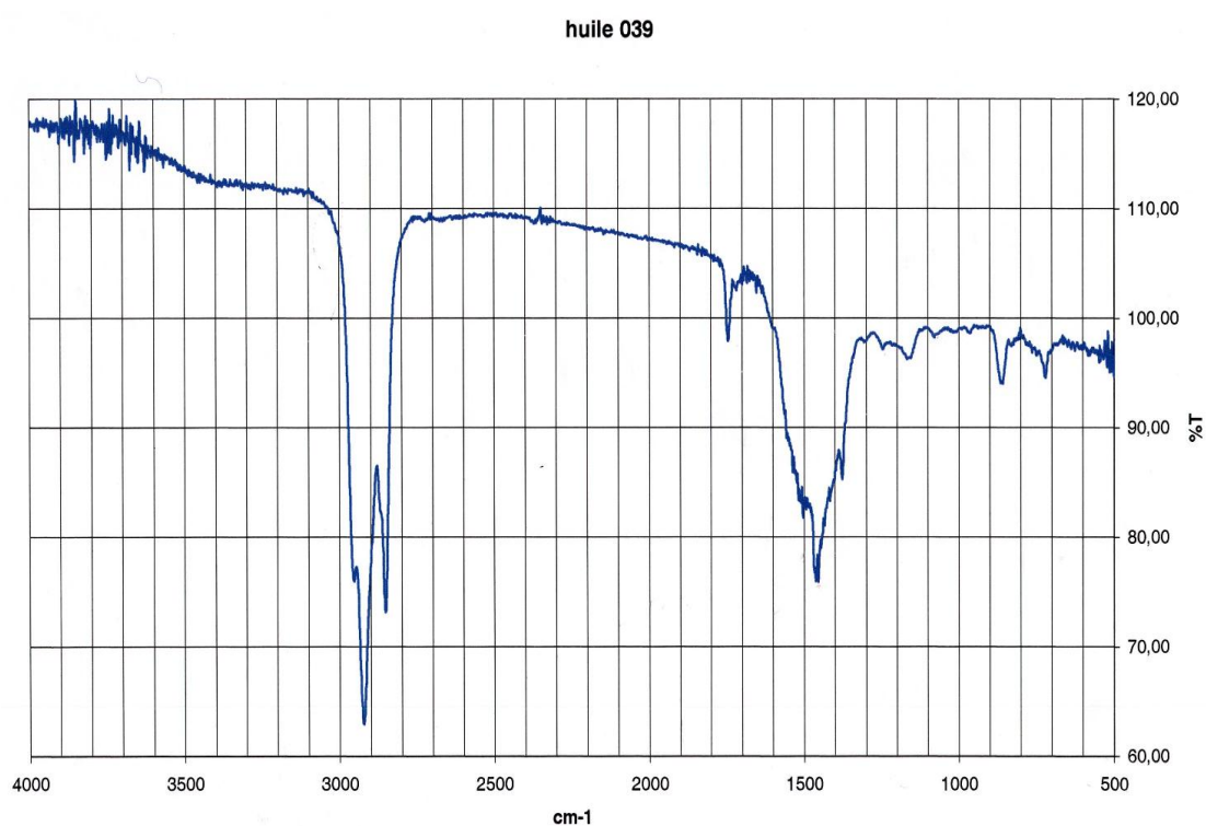
Figure IV-31 : Spectre infrarouge de l'huile 39.
