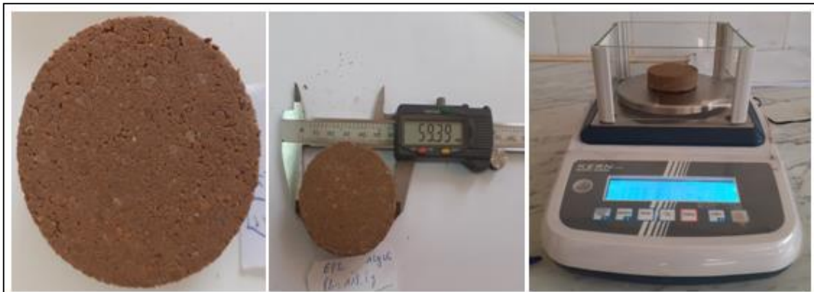
Figure 3.17: Pesage et mesure des dimensions des éprouvettes confectionnées.
