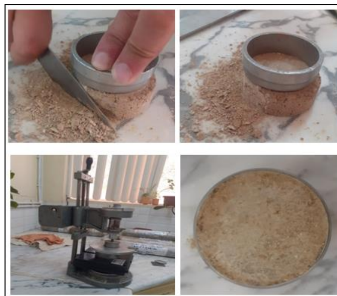
Figure 3.19: Étapes du carottage d'un échantillon du sol pour le test d'oedomètre.
