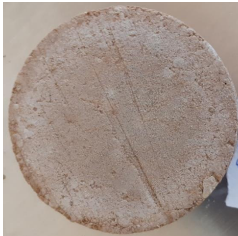
Figure 4.22: État de surface d'un échantillon de sol après séchage.
