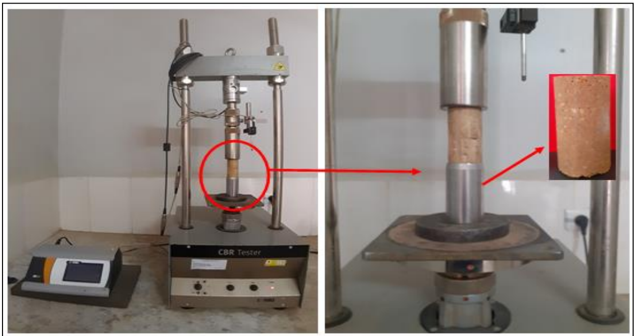
Figure 3.12: Presse CBR utilisée pour le compactage statique des éprouvettes du sol.
