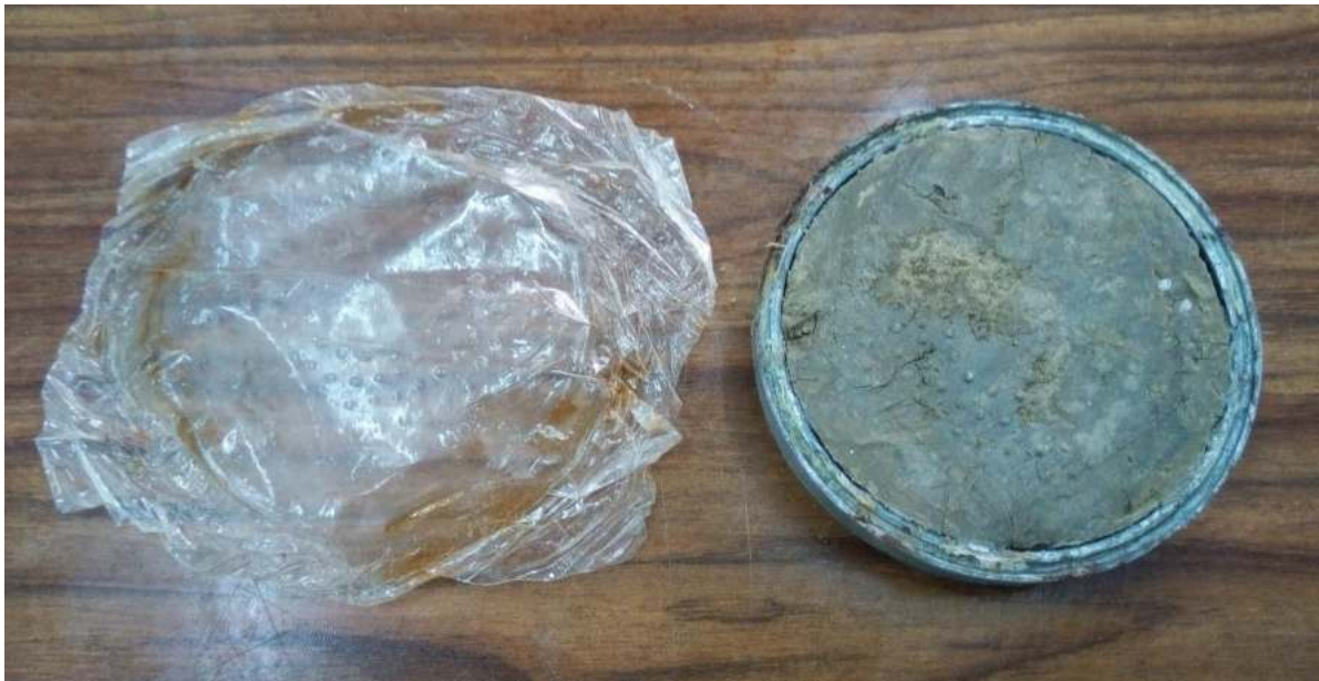
Figure. 7-7. Points de déformations de la surface de l'échantillon et de la membrane semi-perméable dus au chargement mécanique.
