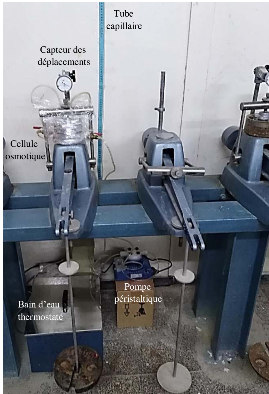
Figure. 7-3. Vue de l'ensemble de l'essai œdométrique utilisant la cellule osmotique à double échange.
