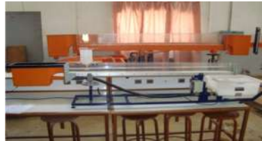
Fig.02.5. Dispositif mis en œuvre pour visualiser le régime annulaire
