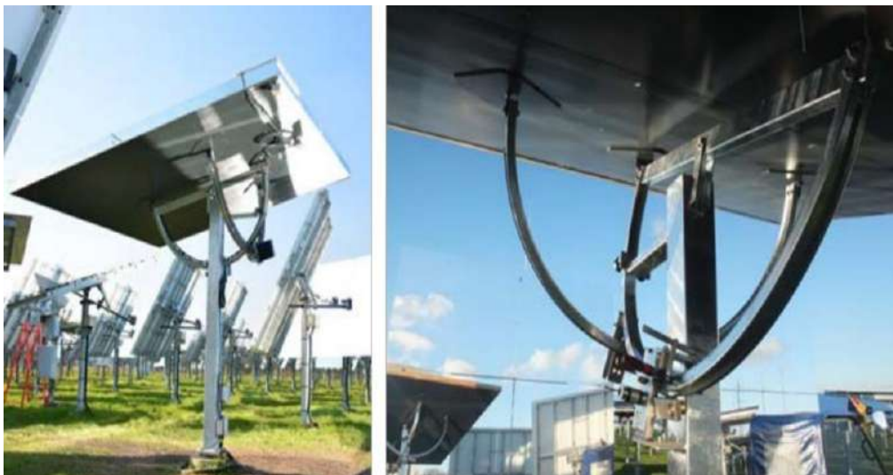
Figure 1.23. Actionneurs de jante de l'héliostat DLR [34].
