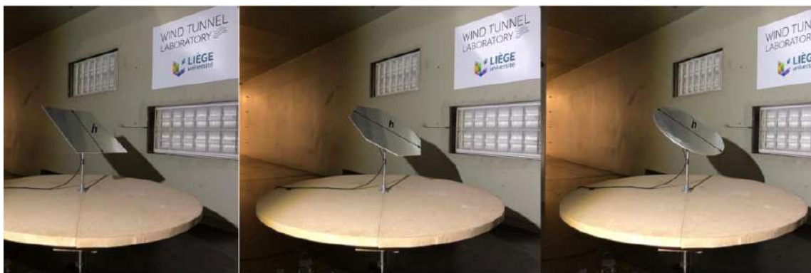
Figure 3.1. Modèles d'héliostat installés dans la section d'essai en soufflerie: carré (gauche), octogonal (centre), circulaire (droite).
