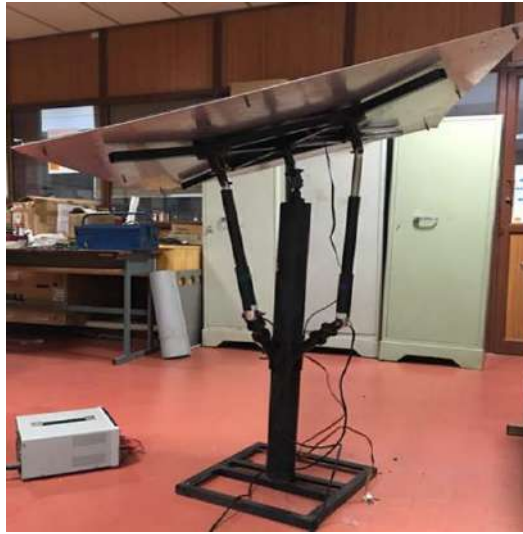
Figure 1.22. Héliostat Pitch/Roll de l'Université Amrita [45].
