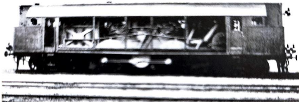
Figure I.9 : Locomotive diesel Sulzer-Klose-Henschel 1912 à entraînement direct ; 1000kW [13].
