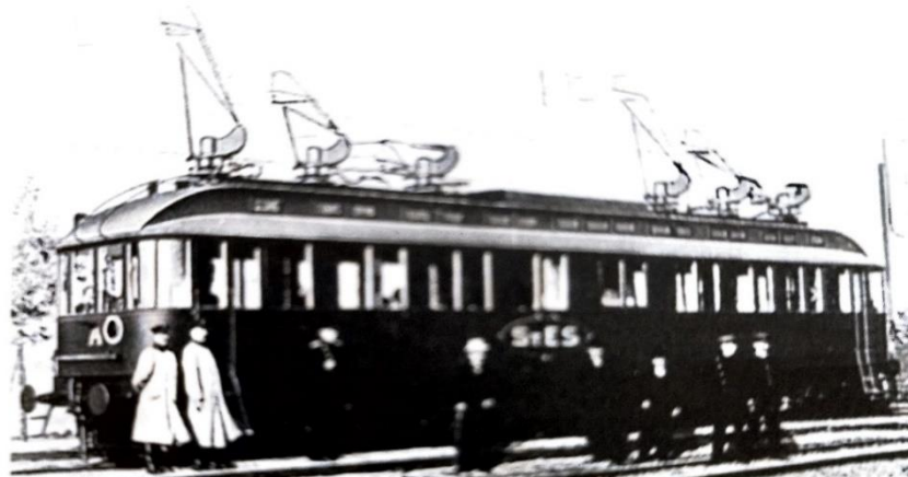
Figure I.5 : Autorail expérimental triphasé à grande vitesse par AEG 1903 ; 210 km/h [13].
