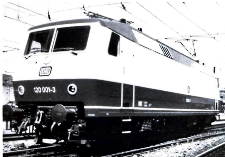
Figure I.11 : Locomotive hautes performances 100 % électrique Classe 120 de la DB ; 1979, 5600 kW (Bombardier Transport).
