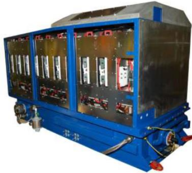
Figure II.18 : Structure à résonance (démonstrateur ABB) [13].
