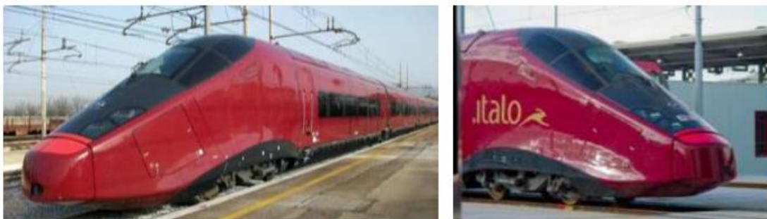
Figure I.13 : Automotrice à grande vitesse (AGV11) de l'opérateur Italien NTV: 2012, 10 MW, 300 km/h [15].
