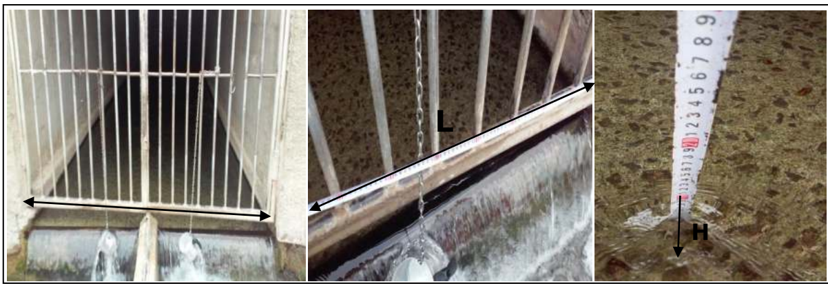
Figure 38: la section mouillée d'exutoire de la source.
