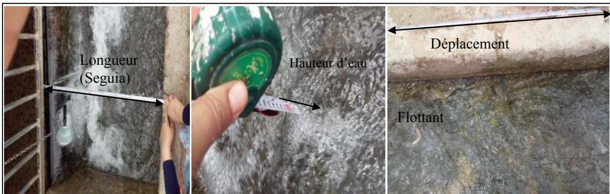
Figure 39: détermination de la vitesse.
