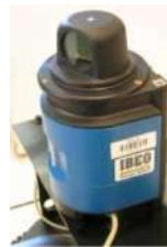
FIGURE B.3 – Un exemple de Télémètre Laser à balayage, fournissant 720 mesures réparties sur 360 degrés, à 5Hz (marque Ibeo)
