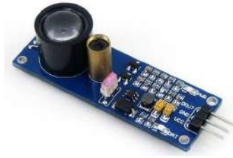
FIGURE B.2 – Un exemple de Télémètre Laser de calcul de distance
