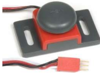
FIGURE 1.18 – Capteur de contact, type « Bumper ».
