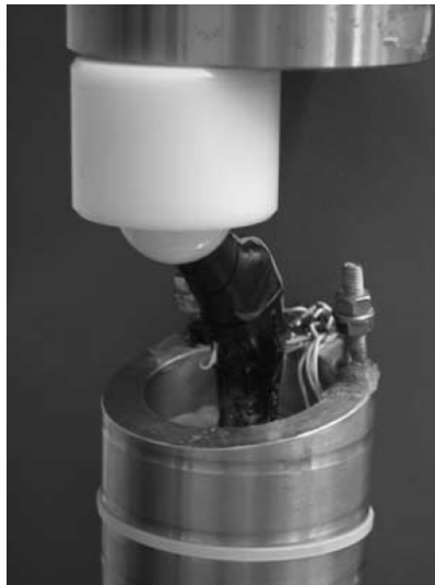
Figure 3.14 Mise en place d'un test de fatigue sur une prothèse de hanche [75].
