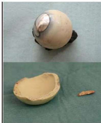
Figure 1.13 Les composants récupérés lors de l'opération (doublure acétabulaire en céramique fracturée et composant fémoral avec revêtement de la tête fémorale en céramique usée) [10].
