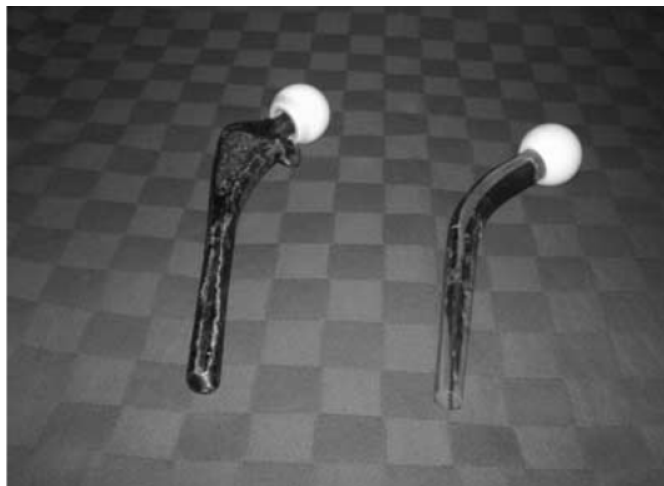
Figure 3.13 Deux prothèses de hanche renforcées par des fibres continues réalisées à l'aide des approches de l'enroulement filamentaire (à gauche) et du moulage par compression (à droite) [76].
