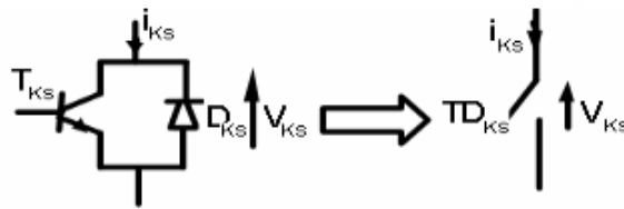
FIGURE 2.6 – Interrupteur semi-conducteur " Transistor–Diode
