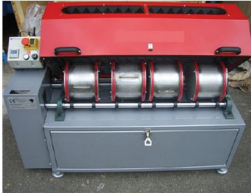
Figure 18: Machine d'essais Micro-Deval composée de 4 cylindres rotatifs
