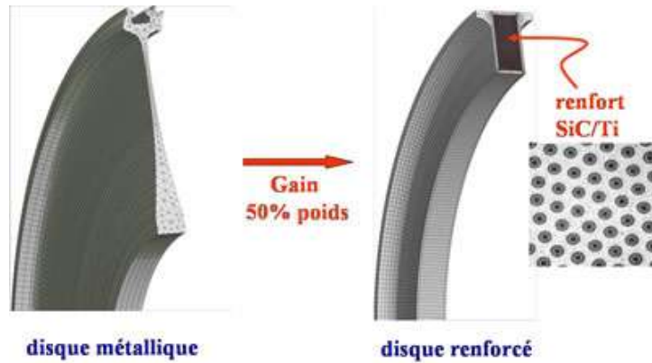
Fig. IV.1: Disque composite à matrice métallique SiC-titane pour application aéronautique.
