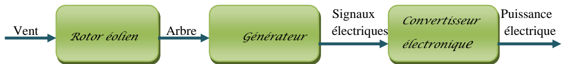
Figure II.1: Structure du système de conversion éolien
