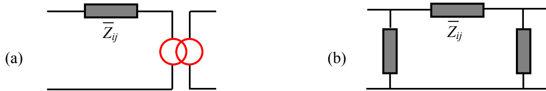
Figure (I.4) : Schéma équivalent d'un transformateur (a) : avec transformateur idéal (b) : par schéma en \pi
