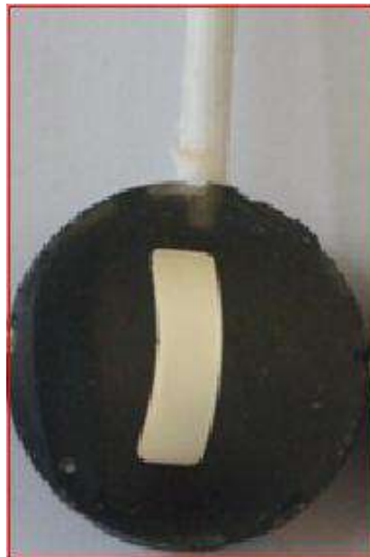
Fig. IV.3 : Echantillon en acier inoxydable 316L enrobé.
