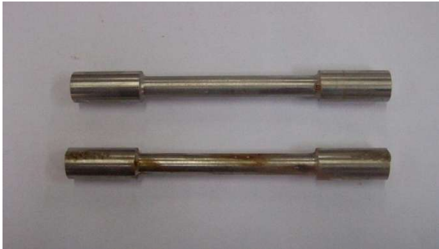
Fig. V.66. Epreuve rincées et séchées après 21 jours d'immersion
