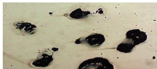
Fig. V.54. Micrographie de l'acier 316L après les tests potentiostatique dans du NaCl, (a) 9g/l et (b) 35g/l.
