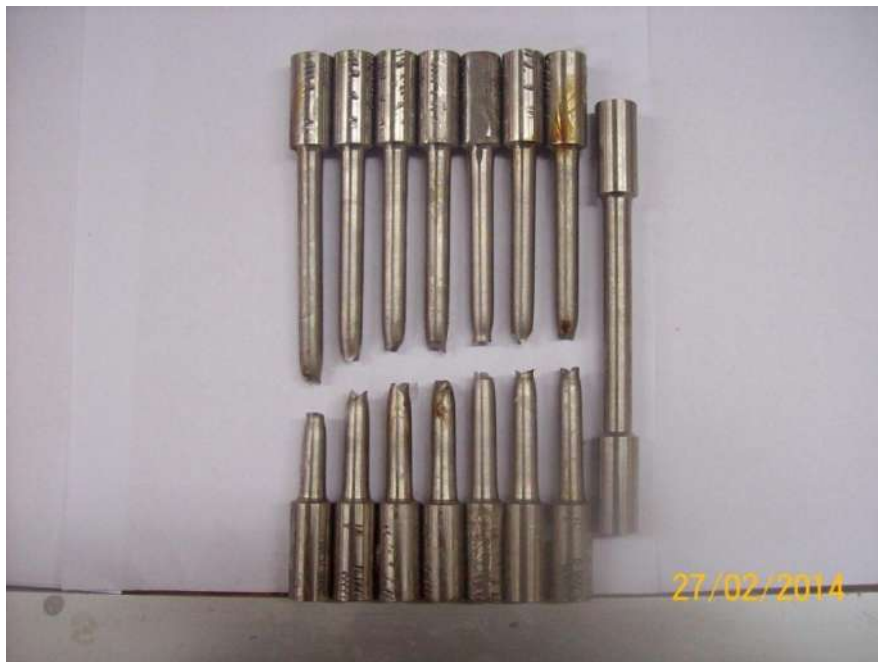
Fig. V.67. Photos des éprouvettes après les tests de traction.
