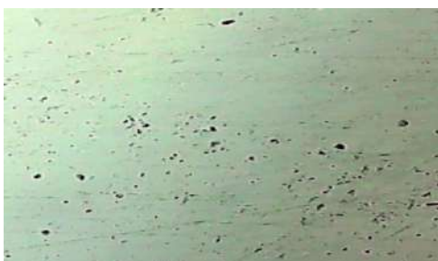
Fig. V.55. Micrographie de potentiel libre de l'acier 304 dans l'eau distillée avec 12,25µl de H 2 O 2
