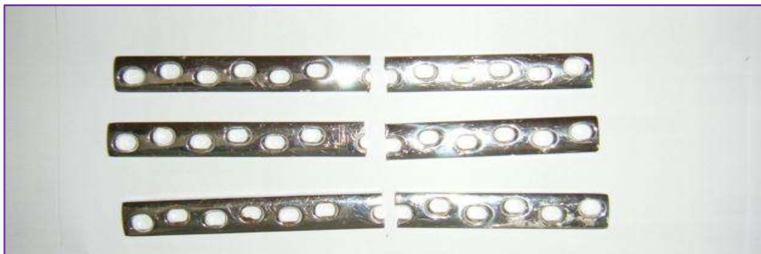
Fig. IV.1 : Implants fracturés après implantation
