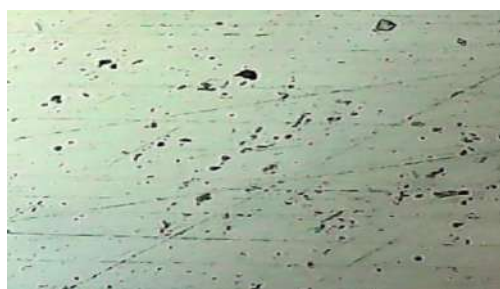
Fig. V.55. Micrographie de potentiel libre de l'acier 304 dans l'eau distillée avec 12,25µl de H 2 O 2
