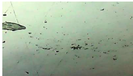
Fig. V.53. Micrographie de l'acier 316L après les tests potentiostatiques dans de l'eau distillée + 12,25 µl H 2 O 2 .
