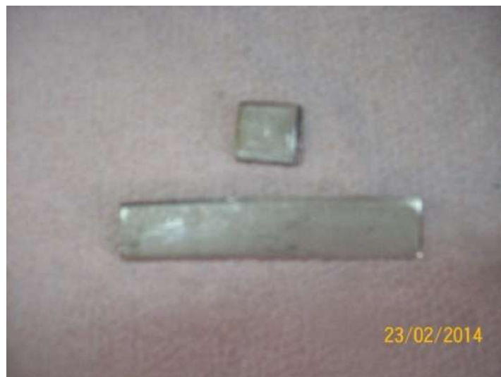
Fig. IV.7 : Echantillon 316L (cr) à l'état brut
