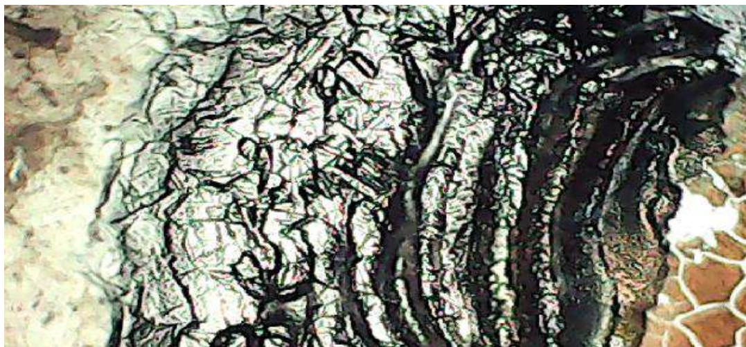
Fig. V.64. Détail d'une piqûre sur l'acier 316L (1,4404), Immersion immédiate, 9 g/l NaCl, 12 \mu l H 2 O 2 , à température ambiante.
