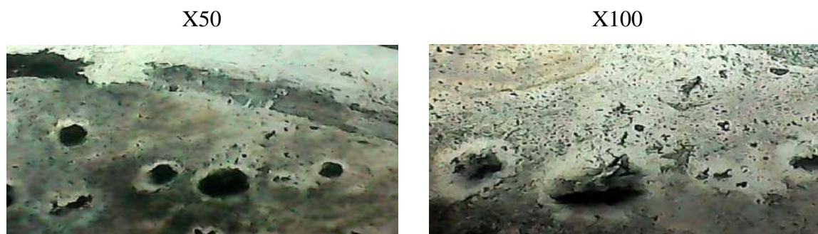
Fig. V.58. Micrographie de polarisation de l'acier 304 dans l'eau distillée avec 9g/l NaCl, 48h immersion à T37°C.
