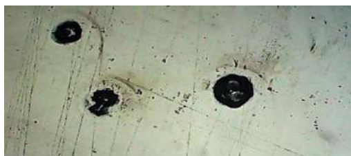
Fig. V.54. Micrographie de l'acier 316L après les tests potentiostatique dans du NaCl, (a) 9g/l et (b) 35g/l.
