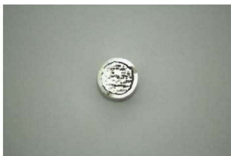
Fig. V.47. Etat de surface après nettoyage
