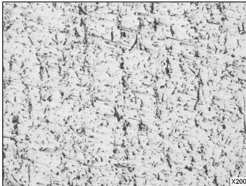
Fig. IV.18 : Micrographie optique de l'acier 304 (X500)
