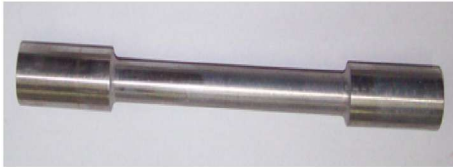
Fig. IV.29 : Epreuve de traction en acier inoxydable 304.
