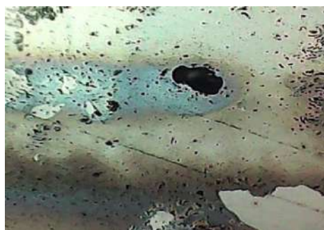
Fig. V.51(b) Etat de surface après polarisation dans 4 nmole/g H_2O_2 24h immersion, T 37°C (X100)
