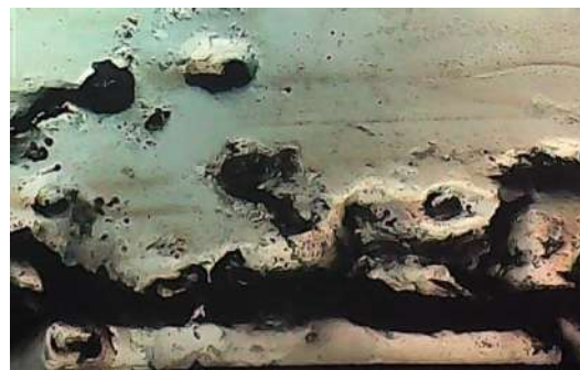
Fig. V.50(d) Alignement des piqures d'un échantillon traité dans 100 nmole/g H_2O_2 , immersion 72h, T 37°C (X100)
