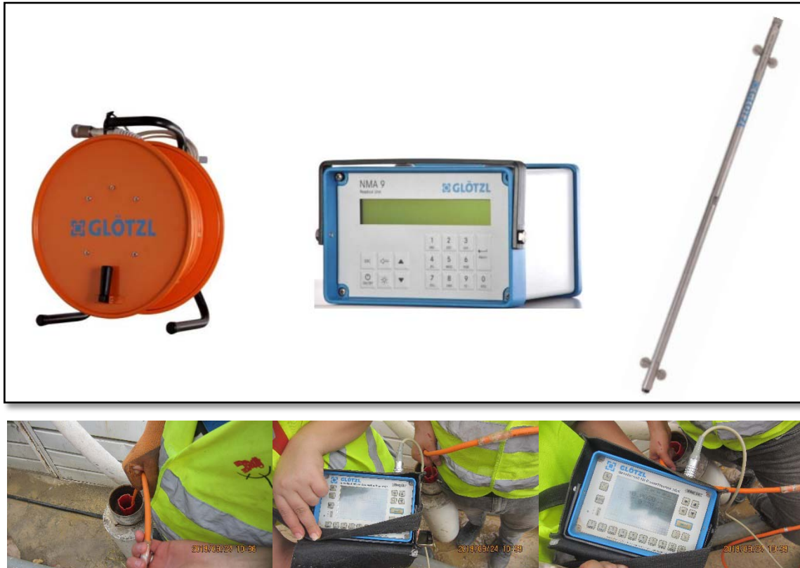
Figure II.12 Tournet de câble, poste de lecture et sonde inclinométrique (de gauche à droite)
