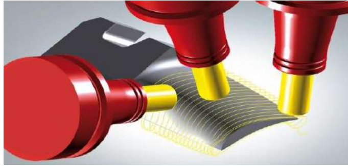
Figure I.21 Fraisage en bout d'aube de turbine 5 axes [13].
