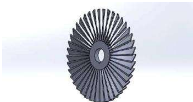
Figure II.5 Modèle d'aube de turbine à gaz [19].
