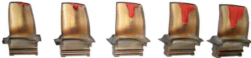
Figure II.40 Illustration de décollements progressifs de la barrière thermique (en rouge) [56].
