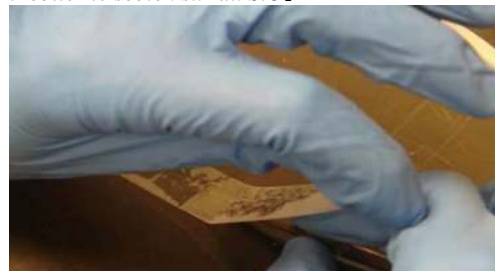
Figure I. 21. Clivage du graphite par la méthode du "Scotch tape" [56].
