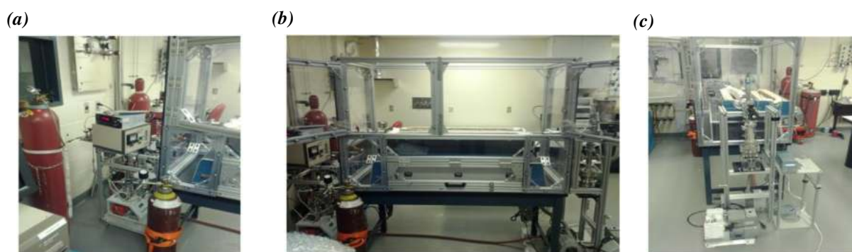
Figure 1. 31. Système utilisé pour la croissance CVD de graphène. (a) Entrée des gaz précurseur. (b) Chambre de croissance. (c) Système de pompage. Image issues de [71].
