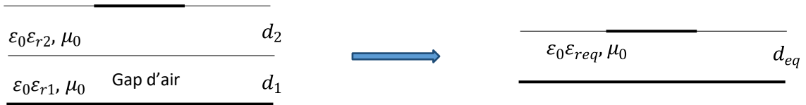
Figure III.4 : Remplacement du substrat bicouche par un substrat monocouche équivalent
