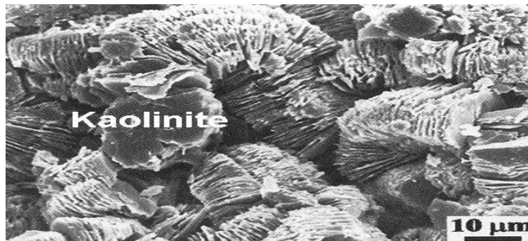
Figure 3.2 Photographies au Microscope Electronique à Balayage de la kaolinite (Mitchell, 1976).
