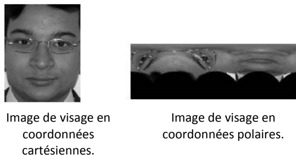
Figure 4.10 Un exemple de conversion des coordonnées cartésiennes aux coordonnées polaires [240].
