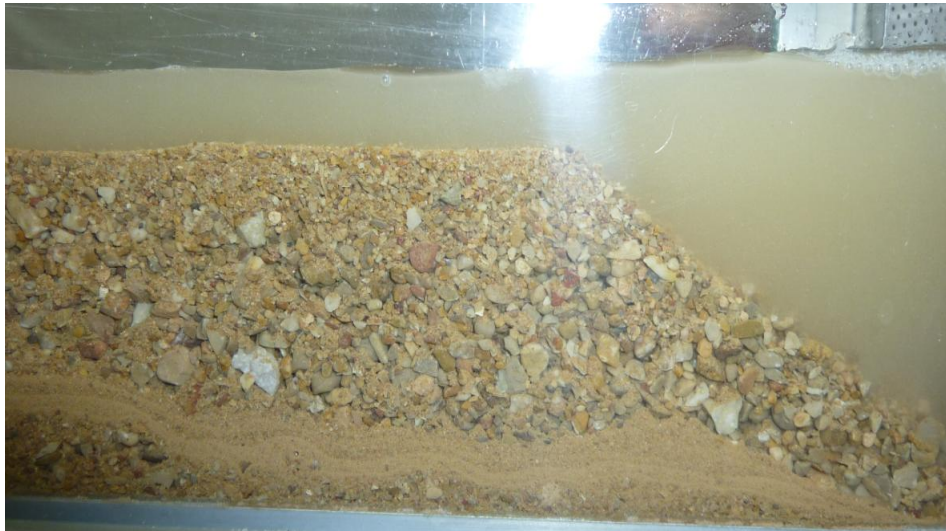
Photo 4-6 : Visualisation de la formation des fins diamètres au fond du canal
