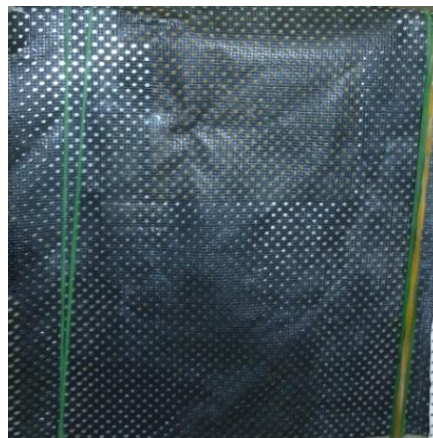
Photo 3-2: Filtre en plastique
