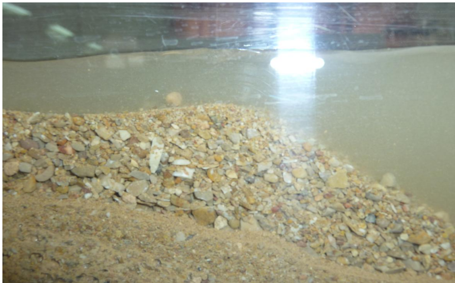
Photo 4-5 : Visualisation de la formation des gros diamètres à la surface du canal
