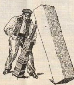
cric n. m. Machine à crémaillère et à manivelle, servant à soulever les fardeaux.
