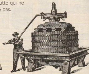
pressoir n. m. Machine qui sert à pressurer le raisin, les pommes, les graines oléagineuses, etc.
