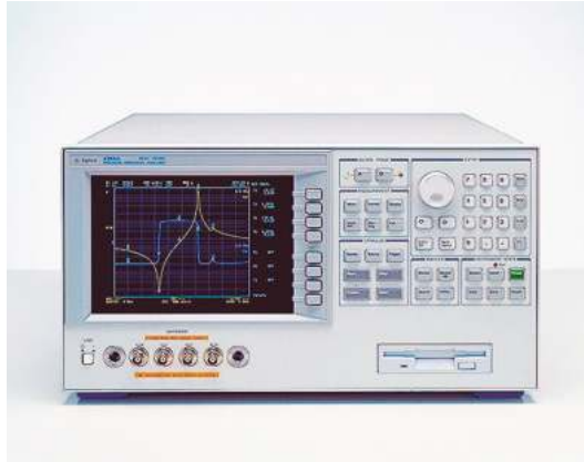
Figure V.1: Analyseur d'impédance de précision AGILENT 4294A.
