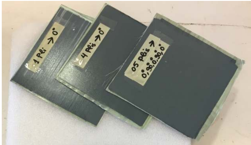
Figure V.9: Echantillons de test en MCFCs.
