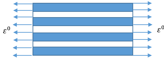
Figure I-14 Direction utilisée par la limite Voigt pour calculer la rigidité du composite
