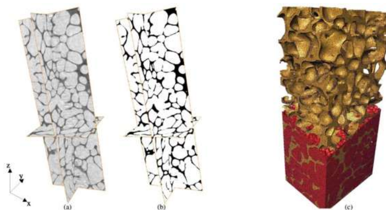
Figure II-1 Microstructure d'un réfractaire électro-fondu zircone-verre caractérisée par microtomographie ( Madi, 2006 ). Volume représenté : 350 \times 350 \times 700 \mu\text{m} , (a) Segmentation du volume pour séparer les phases en présence. (b) Détection de l'isosurface, et triangulation. (c) Maillage obtenu (éléments tétraédriques linéaires, 1 500 000 degrés de liberté). La zircone est ici en rouge, et la phase vitreuse en jaune.
