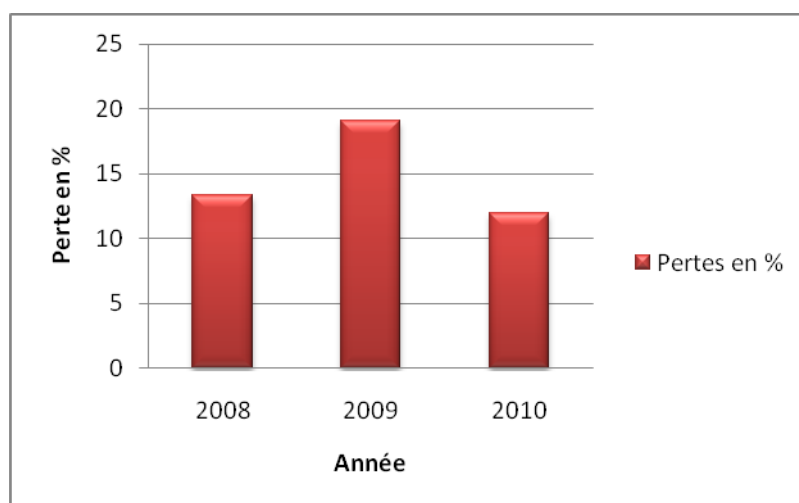
Grafique 5.17: Evolution du pourcentage des pertes en eau au niveau d’adduction de la ville de Batna
