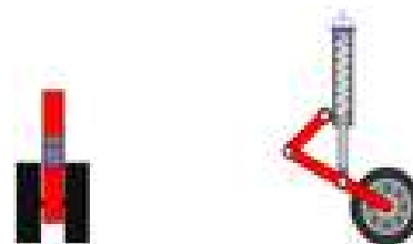
Figure 1.6 - Suspension de type télescopique utilisé dans le domaine de l'aviation (russe)
