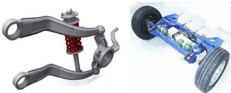
Figure 1.4 - Suspension à « bras tiré » [7]
