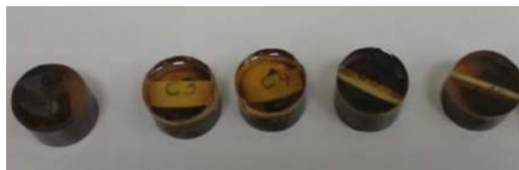
Figure III.28. Echantillons imprégnés dans une résine.
