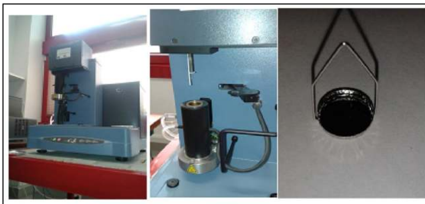
Figure III.25 Appareils de mesure (ATD et ATG) type TGA Q50 et porte-échantillons (laboratoire de recherche C-MADE de l'université UBI Covilhã) Portugal.
