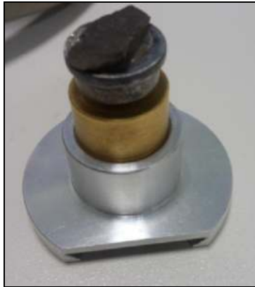
Figure III.29. Fragments de pâte de ciment dans un porte échantillon du MEB
